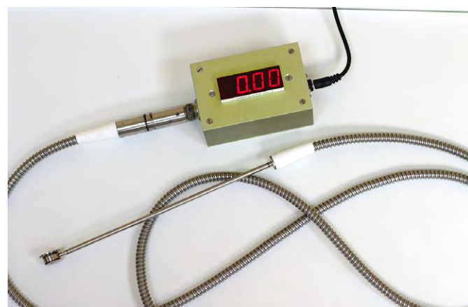
Рис. 1. Оптико-волоконный датчик для определения силы мышц языка Fig. 1. Fibre-optic sensor for detecting tongue muscle strength
