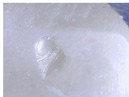
Рис. 3. Микрофотография скола на поверхности образца материала (ув. 10) Fig. 3. Microphotograph of a chip on the surface of a material sample (mag. \times 10 )
