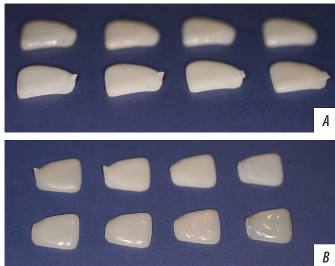
Рис. 3. Образцы без нанесения глазури (А) и с нанесением глазури (В) Fig. 3. Samples without (A) and with (B) the application of the glaze layer
