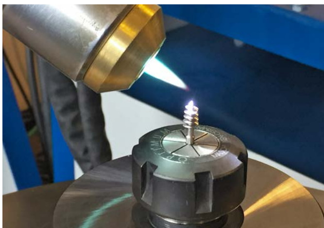
Рис. 1. Нанесение на дентальный имплантат покрытия Pateks [Fig. 1. Process of applying Pateks coating to a dental implant]
