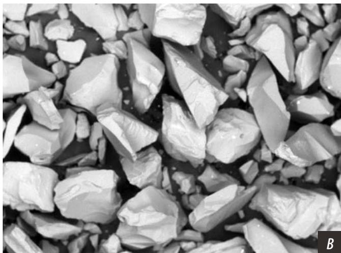
Рис. 1. Порошок электрокорунда зернистостью 90—106 мкм (А) и 250—300 мкм (В) при 100-кратном увеличении
