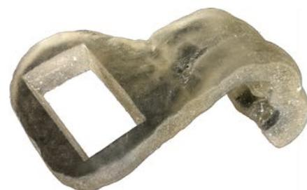
Рис. 4. Стереолитографический шаблон
