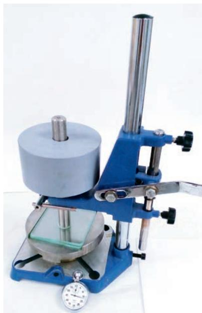
Рис. 2. Нагрузочное устройство ГОСТ 31071-2012 (ISO 6876) для определения текучести фиксирующего материала
