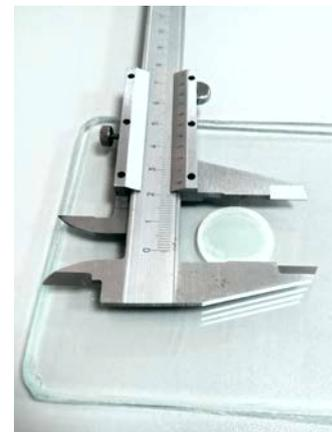
Рис. 3. Измерение диаметра диска фиксирующего материала
