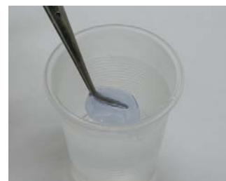
Рис. 5. В горячей воде пластинка LuxaForm размягчается и приобретает прозрачность
